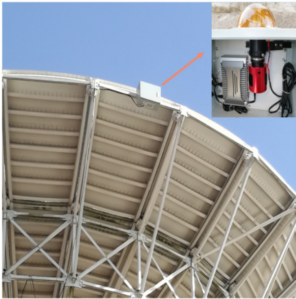
图2 安装在天马13 m射电望远镜上的光学望远镜指向系统 Fig. 2 Optical telescope pointing system mounted on Tianma 13 m radio telescope
